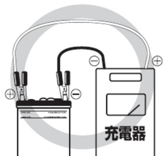
充電電流の設定はP9「6.要項表」の普通充電電流としてください。通電中にクリップを外すなどスパークの出る行為は厳禁です(爆発注意)。
